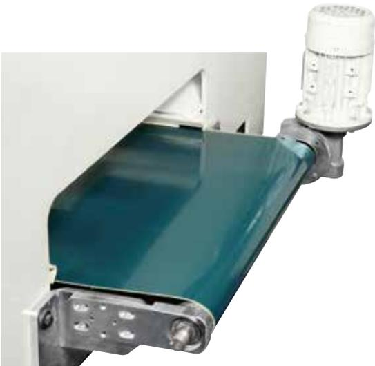
**Tapis de collecte** pour l'évacuation des copeaux et de chutes d'usinage.
