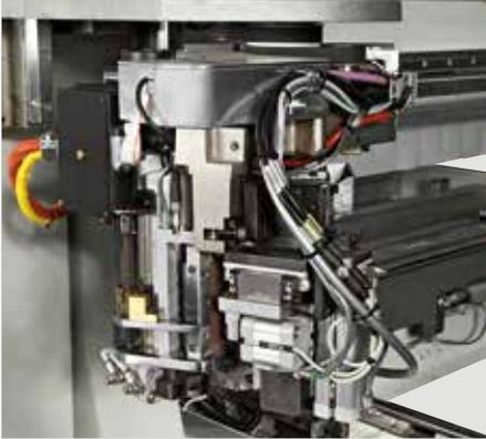
Le nouveau groupe de placage de chants avec application de la colle **directement sur le chant** permet de **réduire le nombre d'organes mécaniques** nécessaires pour sa réalisation, entraînant une augmentation de:
