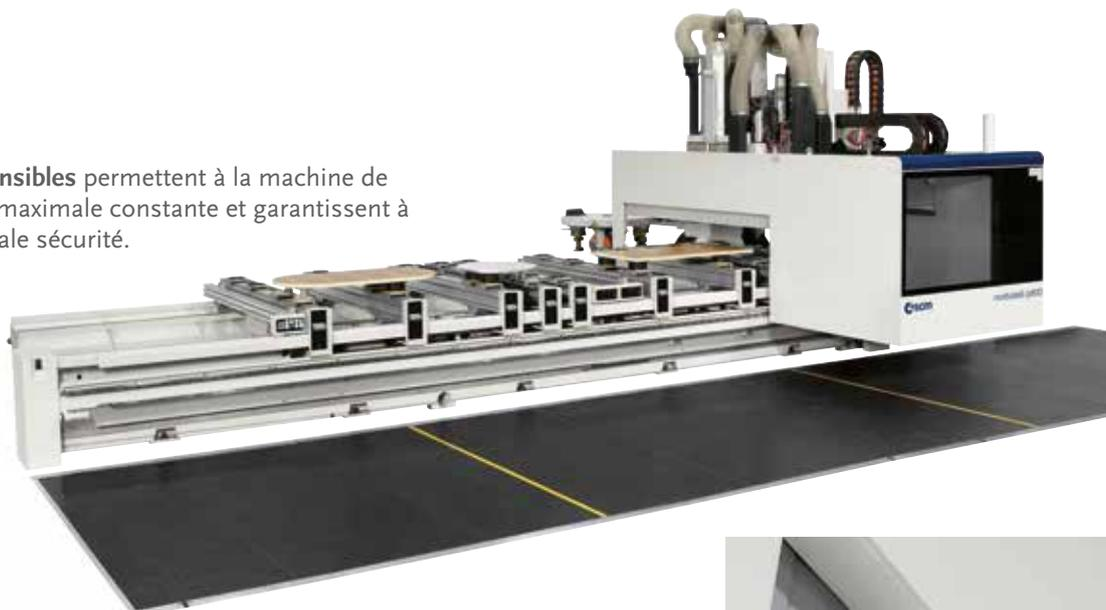
Des couches superposées de bandes latérales en protection du groupe d'usinage, mobiles pour travailler à la vitesse maximale et en totale sécurité.
