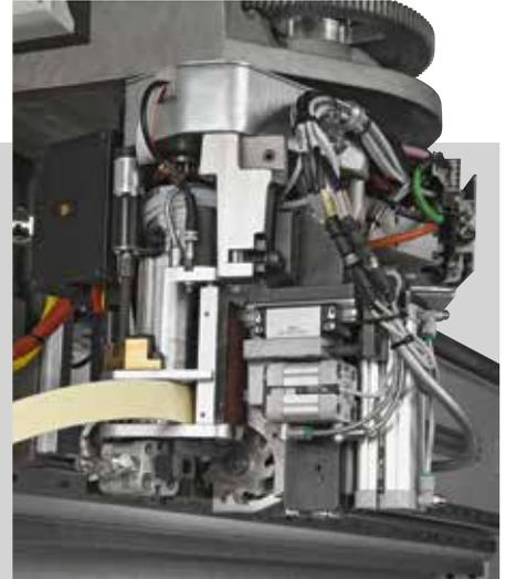
Le bac colle à changement rapide, à design exclusif avec rouleau applicateur à résistance intégrée garantit une uniformité d'encollage et la préservation des caractéristiques chimiques de la colle pour les meilleures performances du produit. La possibilité de remplacement en temps réduits permet des opérations d'entretien préventif ou de changer de type de colle (couleur ou catégorie) en réduisant drastiquement les temps morts.
