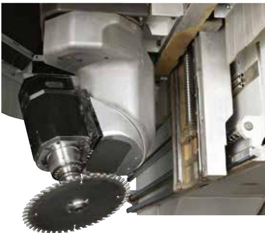
L'unité d'usinage à 4 axes, à puissances de 11 et 15 kW (S6) montée sur un chariot indépendant de l'unité de perçage, exécute toutes les fonctions de fraisage vertical avec utilisation de têtes pour la finition du chant. Axe C 0/360° continu et alimentation des circuits pneumatiques pour têtes de finition chant.
