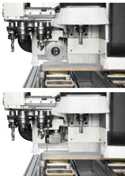
Une exécution simple des rainures sur les parois du meuble grâce au groupe lame intégré avec rotation 0-90°.
