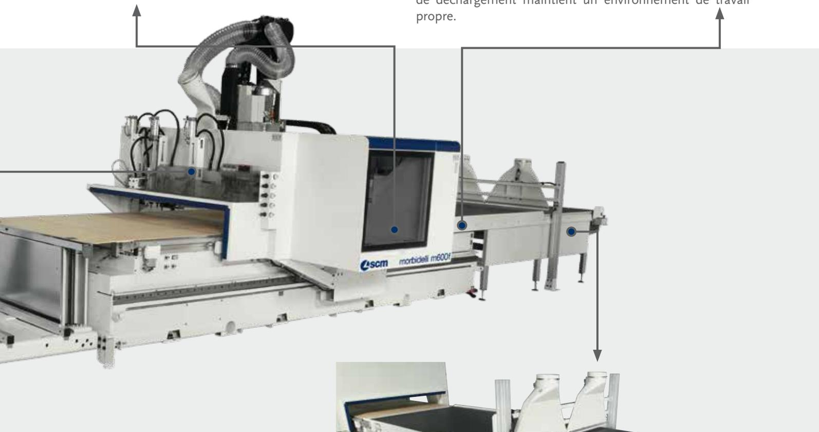
**Pas des poussières** avec le système d'aspiration supérieur pour le nettoyage des pièces et le dispositif de récupération des copeaux positionné au bout du tapis afin d'éliminer tout résidu d'usinage.
