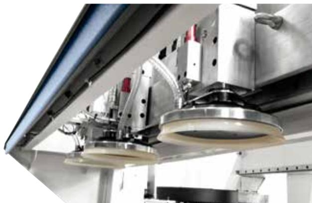
Positionnement précis et rapide des panneaux sur le plan de travail avec un système de ventouses dédié.
