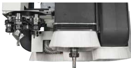
Plus grande efficacité et réduction du temps de travail avec le groupe de fraisage supplémentaire (PBTC) avec électromandrin de 12 kW et magasin Rapid à 6 positions pour exécuter le changement d'outil en temps masqué.
