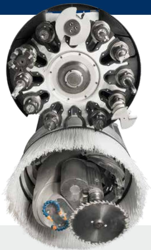
Pas de temps d'arrêt pour le changement d'outil entre les usinages avec le magasin **RAPID 12** « à bord » installé directement sur le groupe opérateur.
