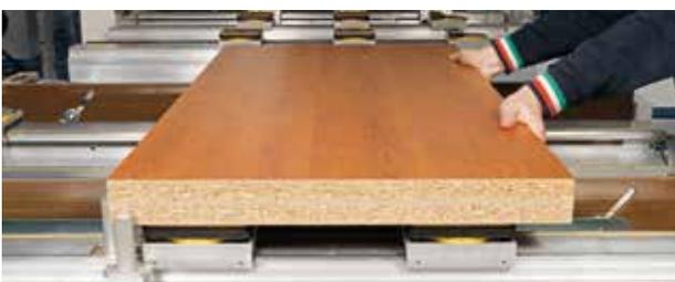
Positionnement facile des pièces lourdes et panneaux de grandes dimensions grâce au dispositif de soulèvement.
