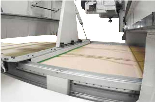
**Productivité à 100%** avec le poussoir qui déplace les pièces usinées sur le tapis de déchargement et simultanément nettoie le plan de travail tandis qu'un nouveau panneau est chargé pour l'usinage.
