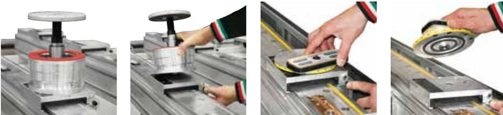
Remplacement facile et en des temps très brefs des ventouses ou des dispositifs à blocage mécanique avec l'exclusif système de fixation rapide.
