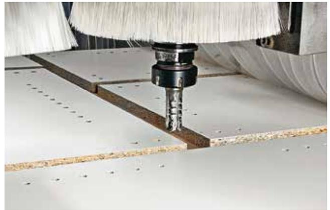
Il est possible de fixer des équipements personnalisés grâce aux rainures exclusives en « T » présentes sur le plan de travail. Positionnement simple et rapide des accessoires de blocage tels que les ventouses MPS et le système MODULSET avec structure à canalisations en surface.
