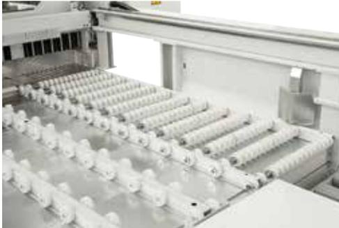
*Plan de travail* constitué de robustes tubes en acier équipés de roues en nylon de plus grandes dimensions pour le déplacement des panneaux, même les plus lourds, sans les endommager.
