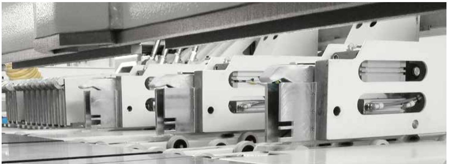
Pincas avec butées pneumatiques on/off pour les panneaux plaqués avec des bords saillants
