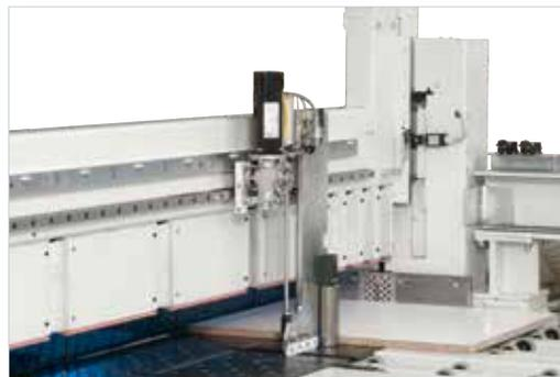
Groupe d'alignement pneumatique latéral arrière pour les coupes transversales: excellent alignement de la pièce contre le guide d'équarrissage et réduction du temps de cycle.
