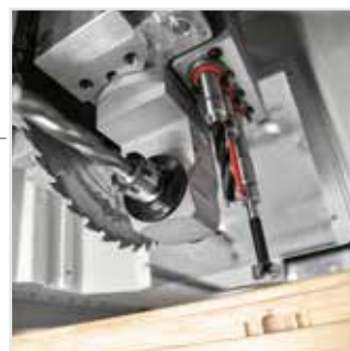
Groupe opérateur BRC-S pour couper, fraiser et percer de façon horizontale et verticale.
