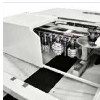
Magasin outil CADDY 35 , intégré dans l'encombrement de la machine.
