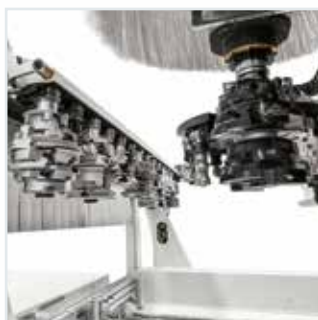
Magasin linéaire FAST 16 à bord , positionné sur le portique mobile, pour réduire au minimum les temps de changement d'outils. Un pick-up dédié aux lames de grand diamètre est également disponible.
