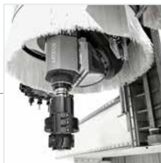
Groupe opérateur à 5 axes KPX avec une électrobroche de 17 kW.
