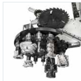
Magasin VELOCE 16 à bord, positionné sur le groupe opérateur, pour exécuter les changements d'outils en temps masqués. Un pick-up dédié aux lames de grand diamètre est également disponible.
