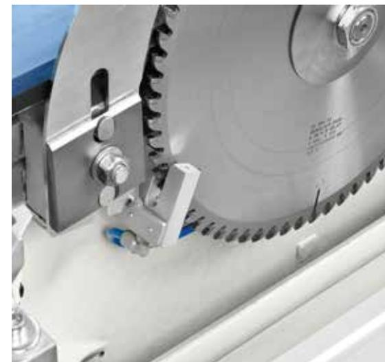
**Dispositif de micro-lubrification de la lame**
