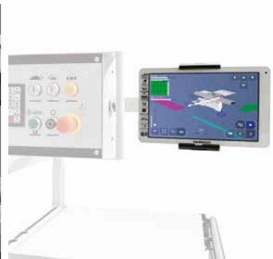
**Support pour tablette réglable positionné sur le panneau de commande suspendu**
