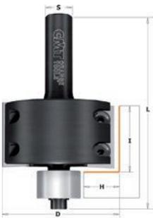
Les fraises avec les jeux de manchons vous permettent de réaliser 17 différentes mesures de feullures et de travailler même sur contreplaqué de petite taille. Pour produire des feullures de dimensions supérieures à 12,7 mm (1/2"), travaillez en plusieurs passages jusqu'à la profondeur désirée. Fraises disponibles avec queue de 12 mm (15/32") et 12,7 mm (1/2").
