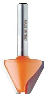
Fraises développées pour la réalisation de lettres avec une pointe de 60° passant au plat du fond par un rayon de 3 mm (1/8"). Ces outils sont été souvent utilisés pour écrire des lettres en relief, le fond plat servant à aplanir le panneau autour des lettres.
