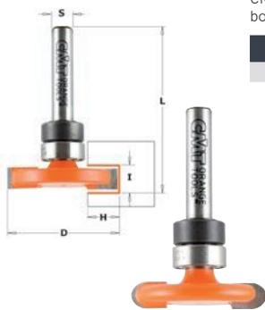
CMT a réalisé cette nouvelle fraise en métal dur de haute qualité pour rainures latérales et gravures pour parquets. Vous pourrez travailler sur bois massif en garantissant d'excellents résultats avec peu d'effort. La fraise est équipée avec une bague de serrage et un roulement.
