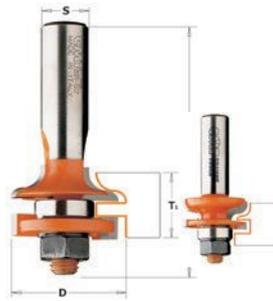
Ces fraises ont été élaborées pour des projets spécifiques qui demandent la production de petits panneaux de portes. Utilisez-les sur les listels en bois dont l'épaisseur est comprise entre 11,1mm et 17,4mm et réalisez des panneaux jusqu'à 70mm carrés.
