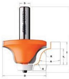
Ces fraises ont été étudiées pour arrondir et finir parfaitement les bords de vos surfaces. Elles peuvent être utilisées avec les fraises 8/980.551.11 pour finir parfaitement le surface entre le haut et son côté. À utiliser sur des défonceuses portatives. Ces fraises disposent du roulement revêtu d'une couche de Delrin® pour protéger vos superficies durant l'usinage.
