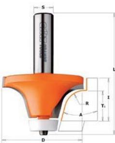
Ces fraises ont été étudiées pour arrondir et finir parfaitement les bords de vos surfaces. Elles peuvent être utilisées avec les fraises 8/980.551.11 pour finir parfaitement le surface entre le haut et son côté. À utiliser sur des défonçuses portatives. Ces fraises disposent du roulement revêtu d'une couche de Delrin® pour protéger vos superficies durant l'usinage.
