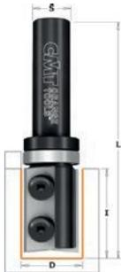
Fraises avec deux plaquettes réversibles fixées par des vis spéciales Torx. La plaquette frontale avec dépouillage de 3° permet du perçage et du copiage de précision. Les fraises sont équipées d'un roulement de guide qui permet de travailler avec un gabarit. Appropriées pour finition, fraisage et rainurage sur panneaux (laminés MDF) et bois dur. À utiliser avec des défonceuses portatives.
