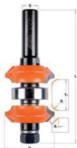
Ces nouvelles fraises permettent la création d'un profil à rayon concave 4,76 mm et de profils doubles avec chanfrein de 45°. Les fraises sont fournies avec des bagues de distance pour régler la distance d'après l'épaisseur du panneau. Utilisez ces fraises sur des défonceuses montées sur votre plan de travail. Évitez l'utilisation de défonceuses portatives.
