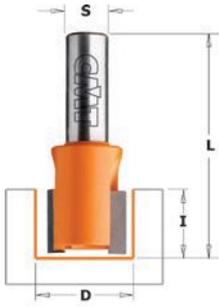
Ces fraises sont idéales pour réaliser des fraisages latéraux de profondeur limitée comme par exemple la pose de charnières.
