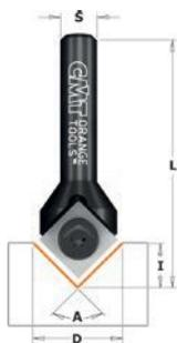
Ces fraises ont été conçues pour réaliser des rainures en forme de V, tout comme des panneaux, des lettres et des bords chanfreinés. En cas d'usure, tourner la plaquette et utiliser les autres côtés pour une plus longue durée. La vis spéciale fixe la plaquette d'une manière sûre et garantit la longévité de coupe.
