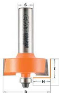
Les jeux comprennent une fraise à feullurer, six roulements, une vis et une clé hexagonale. Pour régler la profondeur de coupe changez le roulement. En ajustant la hauteur de votre défonceuse, la longueur de coupe peut être entre 0 et 12,7 mm ou entre 0 et 19 mm. Pour d'autres profondeurs de coupes utilisez le guide. Jeux disponibles avec queues Ø6mm - 6,35 mm - 8 mm - 12 mm - 12,7 mm .
