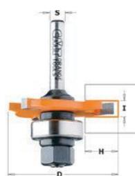
Les possibilités d'utilisation de ces fraises sont nombreuses : escalier, rainurage en général, rainures pour baguettes, fraisage pour assemblage mâle ou femelle ou bien en T. Toutes les fraises ont un dessin anti-recul, des tranchants en carbure micrograin et sont recouvertes d'une résine fluor carbonique P.T.F.E. de couleur orange. Les fraises et les arbres porte-fraises sont disponibles aussi séparément.
