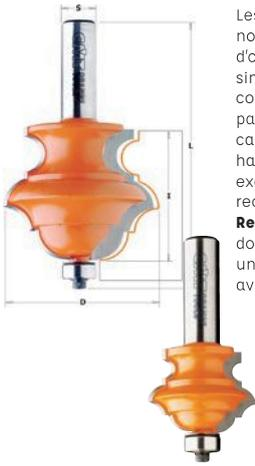
Les fraises multiprofiles permettent de créer de nombreux profils classiques. Il est possible d'obtenir une combinaison infinie de chants simplement en changeant la hauteur de coupe, la position du guide et le nombre de passages. Uniques, elles bénéficient d'un carbure de tungstène micrograin de très haute qualité, d'un revêtement anti-adhérent exclusif en P.T.F.E. orange et surtout d'un anti-recul indispensable.
