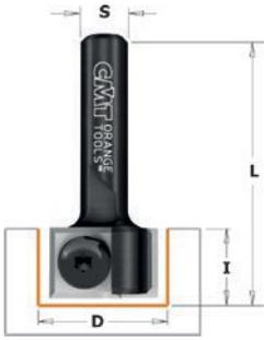
Fraises à coupe droite avec deux plaquettes réversibles fixées par des vis spéciales Torx. La coupe frontale dépouillée de 3° permet l'exécution du perçage et rainurage. Appropriées pour fraiser, rainurer et coupes de finition sur panneaux et bois dur. À utiliser sur défonceuses portatives et machines stationnaires.
