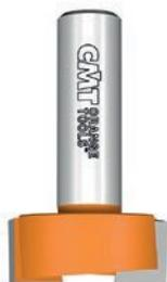
Le profil réalise des entailles de toutes dimensions, charnières, paumelles, limons d'escalier, etc. Un angle axial négatif crée une coupe parfaite et une excellente évacuation des copeaux. Le revêtement en P.T.F.E. orange anti-adhérent associé au carbure micrograin trouve là son meilleur usage. À utiliser avec défonceuses ou pantographes CNC pour travailler le bois et ses dérivés.
