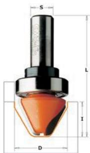
Fraises développées pour la réalisation de lettres avec une pointe de 60° passant au plat du fond par un rayon de 3 mm (1/8"). Ces outils sont été souvent utilisés pour écrire des lettres en relief, le fond plat servant à aplanir le panneau autour des lettres.
