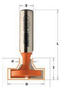
Ces fraises pour rainure en T permettent la réalisation d'encadrements, de plaquettes ou de décorations en bois avec parois. L'outil effectue un perçage d'entrée. Le pantographe avance: le diamètre inférieur (d) coupe une fissure, le diamètre supérieur (D) fait une fissure plus grande sous la surface. Cette opération donne un appui pour les têtes de vis ou de rivet.
