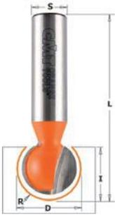
Ces nouvelles fraises vous permettent de créer des canaux pour câbles et tuyaux en un seul passage. Diminuez la tension de la fraise en fraisant une première rainure avec une autre fraise à coupes droites.
