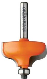
Ces fraises offrent de nouvelles possibilités décoratives au menuisier qui permettant d'élargir sa gamme. Chaque outil est doté d'une mise en carbure de tungstène de haute qualité recouverte de résine fluorocarbonique P.T.F.E., de couleur orange, et fixée à chaud.
