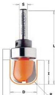
Les fraises idéales pour fabriquer des plateaux, des bols, planches à découper, ou tout autre objet en bois. Les angles arrondis tirent le rayon intérieur, tandis que les côtés et la partie inférieure de l'arête de coupe crée une surface plane et lisse. Équipées d'un roulement guide pour plus de précision et pour le travail avec un gabarit.
