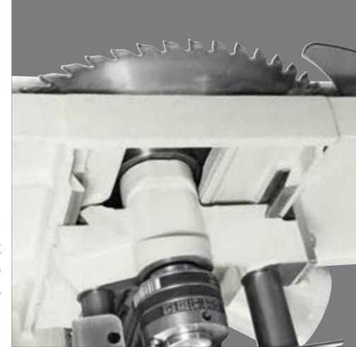
La rotation du corps oscillant du groupe scie s'effectue sur 2 appuis en demi-lune de diamètre 120 mm: une solution rigide et fiable dans le temps.
