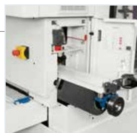
Groupe de brosses interchangeable en sortie du plan de travail pour une grande flexibilité d'usage.
