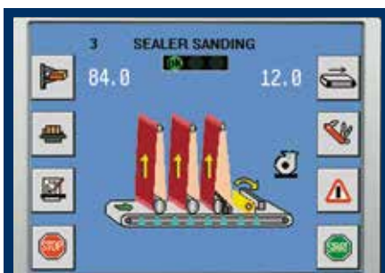
Contrôle "PRO-SAND" avec écran LCD couleurs de 5,7" ou 10,4".
