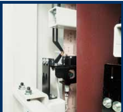
Photocellule pour l'oscillation des bandes pour une plus grande durée de vie.
