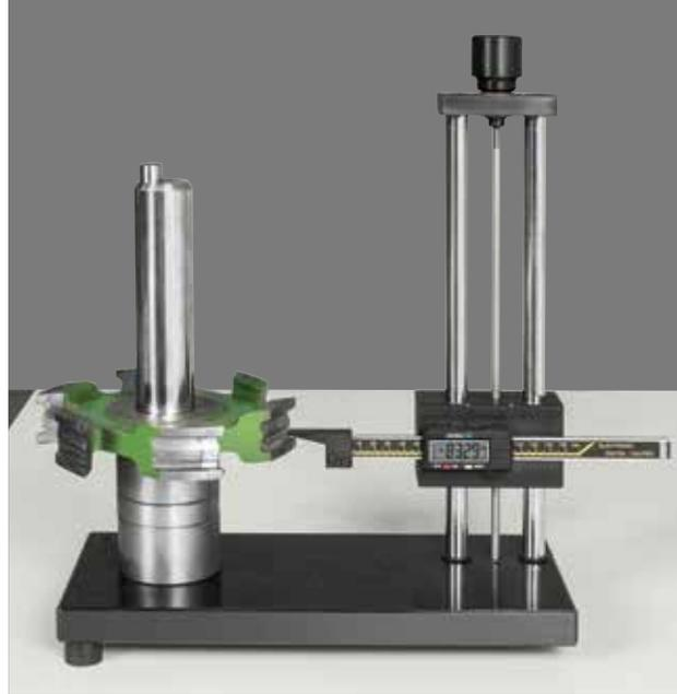
**« Preset 25 »: calibre pour le mesurage du diamètre outils**
