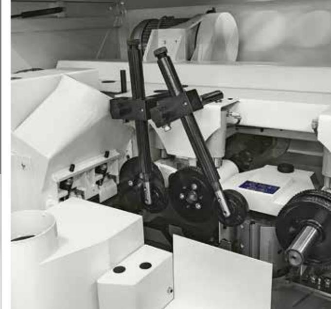
**Presseurs verticaux avec roue folle positionnés devant les arbre universels**
