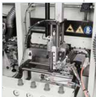
Groupe arrondisseur ROUND 1: finition des angles sur panneaux droits et profilés.
