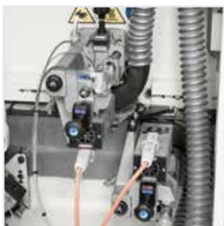
Groupe d'affleurage R-K: changement rapide et automatique d'usinage entre chant mince, épais et boi massif.
