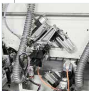
Groupe arrondisseur ROUND X-MULTIEDGE à 2 moteurs avec les axes à cn pour un réglage automatique.
