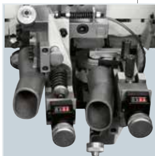
Groupe racleur de chant RAS-K Il élimine les marques laissées par les outils sur les chants en plastiques.
