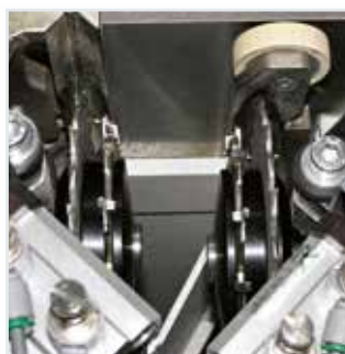
Groupe de coupe en bout K-2 Radius: coupe et arrondissement en une seule opération.
