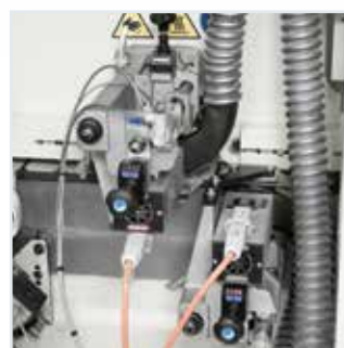
Groupe d'affleurage R-K: Changement rapide et automatique d'usinage entre chant mince, épais et bois massif.
