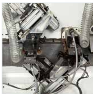
Groupe arrondisseur ROUND X à 2 moteurs Qualité optimale du panneau avec l'arrondissement et l'affleurage du chant simultanés.
