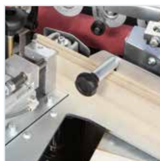
Groupe d'encollage VC-M: chant en bois massif jusqu'à 5 mm d'épaisseur.
