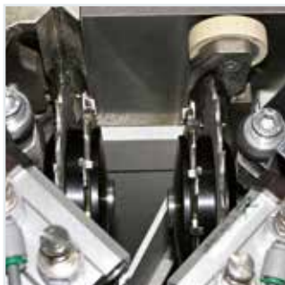
Groupe de coupe en bout K-2 Radius: coupe et arrondissage en une seule opération.
