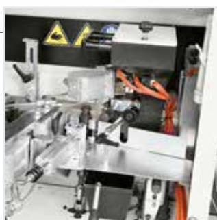
Bac à colle SGP-E Application homogène de la colle sur n'importe quel matériau.
