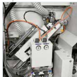
Groupe de coupe en bout K/SEL Finition excellente grâce à l'inclinaison des lames.
