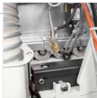
Groupe anti- adhérent AAL: propreté optimale du panneau avec la vaporisation du liquide antiadhésif.
