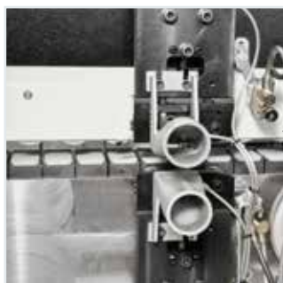
Groupe racleur de colle RC-N: il élimine les éventuels surplus de colle dans la jonction chant/panneau.
