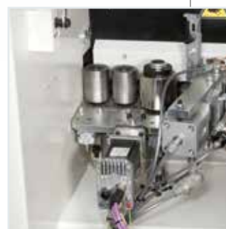
Rouleaux de pression avec positionnement à axe à cn et intervention programmée.
