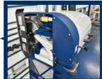
Chariot lame avec lame principale et inciseur à moteurs indépendants
