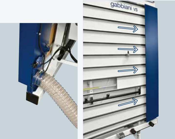
Convoyeur latéral pour l'évacuation des poussières
